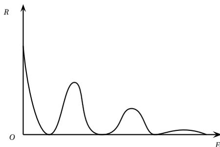
Ramsauer et Townsend ont montré expérimentalement que pour certaines valeurs de l'énergie  $E$  d'un faisceau monoénergétique d'électrons de basse énergie, certains gaz rares (Hélium, Néon, ou argon) sont parfaitement transparents.
